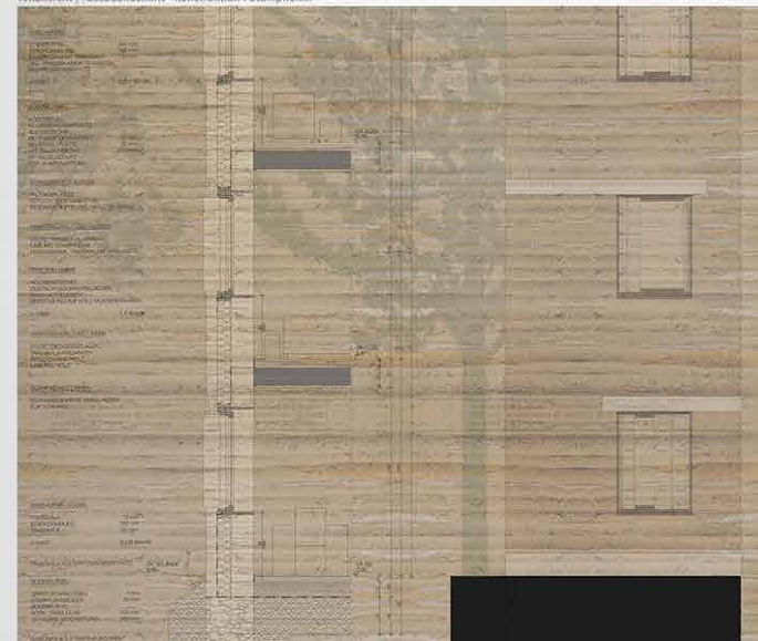
Teilansicht | Fassadenschnitt - Konstruktion | Stampflehm
