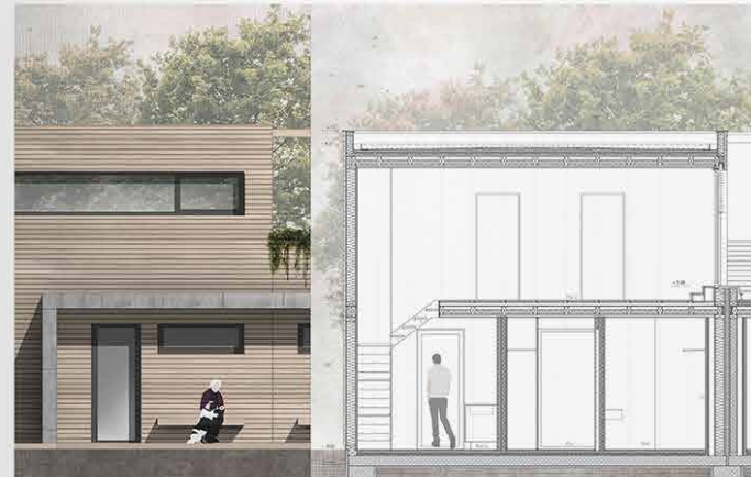
Teilansicht | Schnitt - Konstruktion | Holzrahmenbauweise
