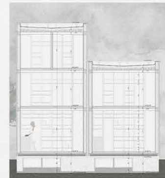
Grundriss DG | Teilschnitt - Konstruktion | Holzzahnenbauweise
