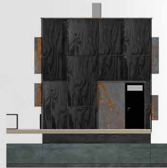
Ansicht Nord - Konstruktion | Holzrahmenbauweise
