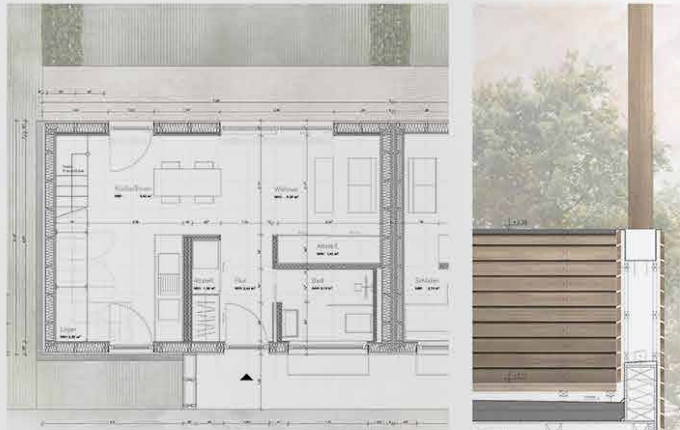
Teilgrundriss EG - Konstruktion | Holzrahmenbauweise
