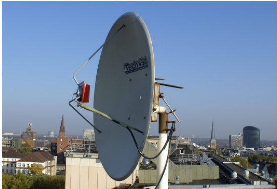
Testaufbau einer neuentwickelten Hochgewinnantenne für den 2,4GHz- und 5GHz-Bereich auf der Dachmeßstrecke
