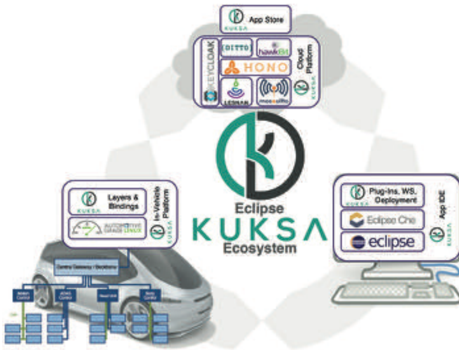
◀ Abb. 1: Das Eclipse KUKSA Ökosystem bestehend aus einer In-Vehicle und Cloud Plattform sowie einer integrierten Entwicklungsumgebung Fig. 1: The Eclipse KUKSA ecosystem including an in-vehicle and cloud platform as well as an integrated development environment
