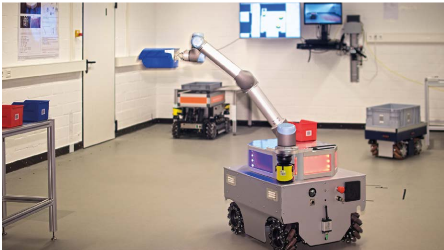
◀ Abb. 1: Mobiler omnidirektionaler Manipulator für die Mensch-Roboter-Kooperation in der Intralogistik
