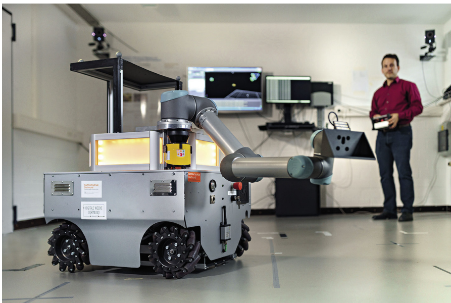
◀ Abb. 1: Mobiler omnidirektionaler Manipulator für die Mensch-Roboter-Kooperation in der Intralogistik
