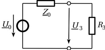
Im Leerlauf ( $R_3 = \infty$ ) entspricht die Spannung an den Klemmen der bereits ermittelten Spannung  $\underline{U}_{3L}$ , d. h.,
