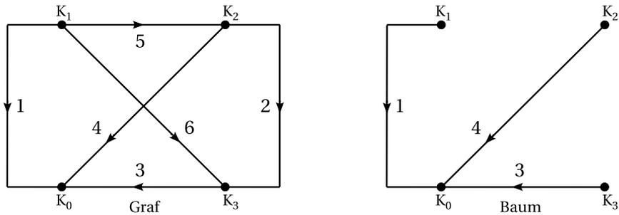
Unabhängige Spannungen:  $\underline{U}_1$ ,  $\underline{U}_3$  und  $\underline{U}_4$ .
