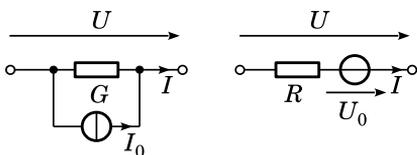
Die Spannung  $U$  sowie der Strom  $I$  müssen in beiden Zweipolen identisch sein. Mit  $R = 1/G$  erhalten wir aus
