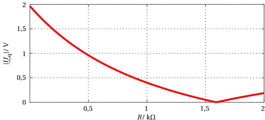
Die Frequenz ist auf den Wert  $f = 1 \text{ kHz}$  eingestellt. Die Brücke ist bei der Einstellung des Doppelpotenzimeters auf den Wert
