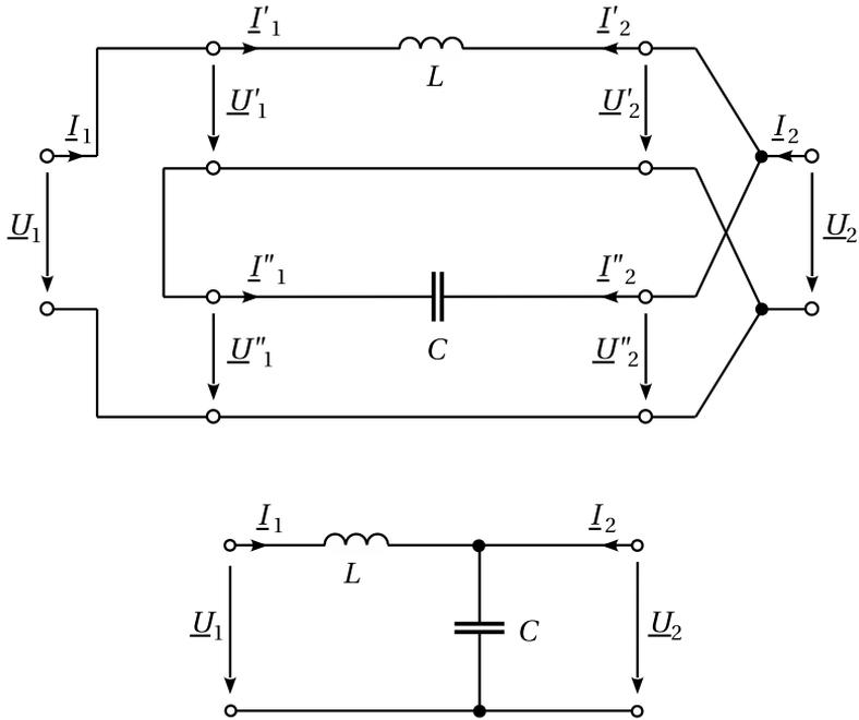
Durch die Reihen-Parallel-Schaltung ist die Torbedingung bei den Zweitoren  $N'$  und  $N''$  nicht mehr erfüllt. Dies ist sofort ersichtlich, wenn Tor 2 des Gesamtzweiters  $N$  im Leerlauf betrieben und eine Spannung an Tor 1 angelegt wird. Dann fließt der Strom  $\underline{I}'_1 = -\underline{I}'_2 = \underline{I}''_2 = -\underline{I}''_1$  in die untere Klemme des Tors 1 von  $N'$  und verletzt somit die Torbedingung.
